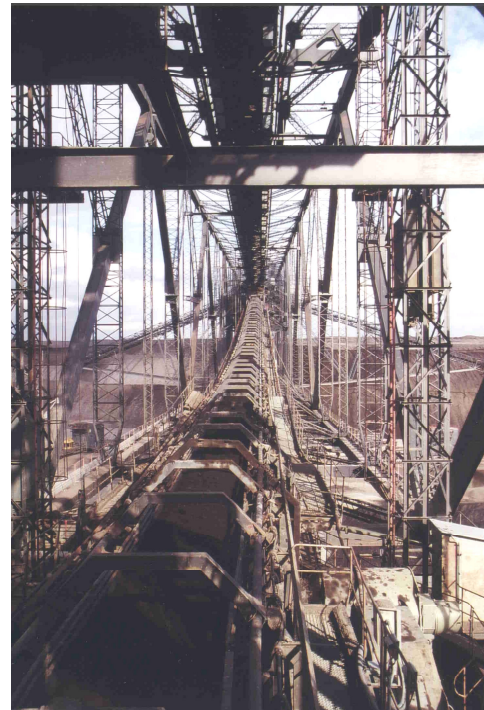
Abb. 2: Tagebau Welzow-Süd mit Abraumförderbrücke vom Typ F60 (BBG)
